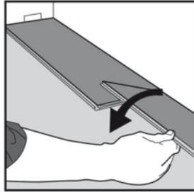
Drücken Sie die 2. Diele leicht an das Ende der 1. Diele und falten Sie dann gleichzeitig die 2. Diele herunter. Wenn die Feder auch richtig eingerastet ist, drücken Sie die 2. Diele nochmals an die 1. heran. (oder leichter Hammerschlag mit Schlagklotz)
