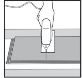
Bitte schneiden Sie die Diele mit einer Stichsäge (Hartholzaufschnitt nach unten) oder mit einer Handsäge (Laufschicht nach oben).
