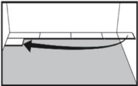
Der Abschnitt aus der 1. Reihe sollte min. 50 cm lang sein, dann wieder einen Distanzklotz 10 mm an der Wand verwenden.
