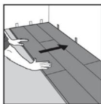
Nach 3 Reihen fügen Sie auch Distanzklotze an der Längsseite der ersten Reihe ein.
